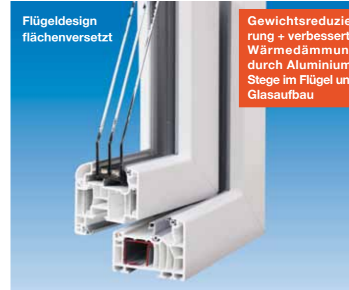
PREMIUM luxtop – die ökonomische Ausführung mit optimaler Wärmedämmung und solarer Nutzung, Profilaussteifung mit Stahl und Aluminium-Stege
